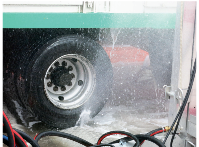
Verstärkter Düsenstrahl im Unterboden- und Felgenbereich
