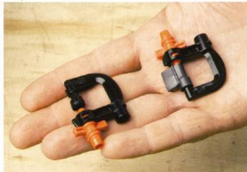
Je nach Stall und Einsatzzweck sucht Meier-Brakenberg aus 150 Düsen die passende aus. Links im Bild eine Pralltellerdüse, rechts davon eine Rotordüse.
