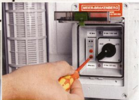
Zum Ändern der Sprühphasen (9 bis 180 Sekunden) und der Pausen benötigt man keine Betriebsanleitung.
