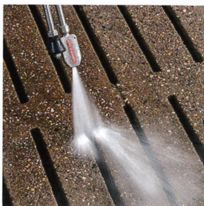
Einen deutlich besseren Reinigungseffekt stellten wir vor allem beim Reinigen der Schlitze fest.
