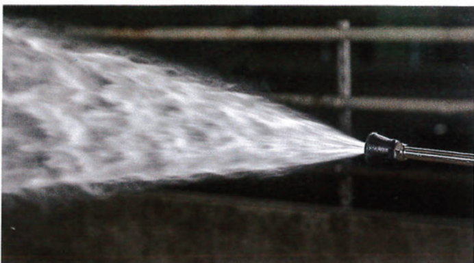
Die Flachstrahldüse erreicht mit ihren sehr feinen Tropfen einen relativ gleichmäßigen Sprühkegel.
