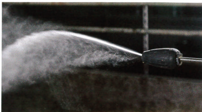
Das Sprühbild der Rotordüse zeigt, dass hier ständig ein sich im Kreis drehender Punktstrahl unterwegs ist.
