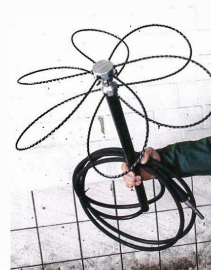
Die gebogenen Libellenflügel halten den Wäscherkopf in der Schachtmitte.
