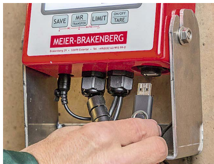
Per USB-Stick (2.0) können die Wiegedaten nun auf den PC im Büro übertragen werden.
