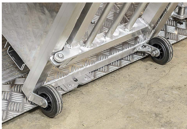
Der Boden der Niederflurwaage misst nur noch eine Höhe von 5 cm (rechts). In Verbindung mit einer schrägen Rampe aus Aluminium beträgt damit die Auftrittshöhe nur noch 2 cm. Auch ohne ein Einlassen in den Boden kann so die Waage mit Geräten selbst bei kleinen Rädern überwunden werden.
