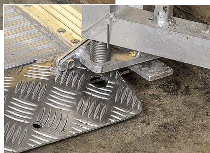
Federn an den Türen sorgen dafür, dass sie nach dem Entriegeln zuverlässig offen bleiben.
