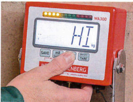
Durch Eingabe von drei Gewichtsbereichen kann man die Ampelfunktion individualisieren.
