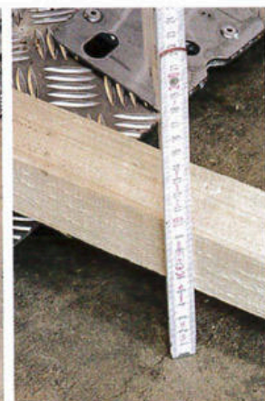
Der Boden der Niederflurwaage misst nur noch eine Höhe von 5 cm (rechts). In Verbindung mit einer schrägen Rampe aus Aluminium beträgt damit die Auftrittshöhe nur noch 2 cm. Auch ohne ein Einlassen in den Boden kann so die Waage mit Geräten selbst bei kleinen Rädern überwunden werden.
