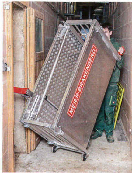
Auch wenn der Wiegecomputer übersteht: Die Einzeltierwaage passt durch fast jede Stalltür.
