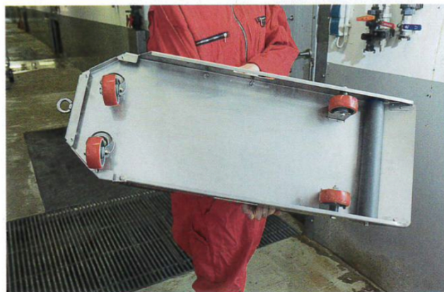
Jedes Rad ist für eine Traglast von 130 kg ausgelegt. Selbst beladen rollt die Karre extrem leicht über ebenen Beton.
