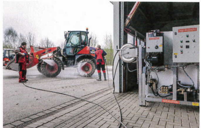
Neben den mobilen Geräten bietet Meier-Brakenberg stationäre Hochdruckreiniger mit Frequenzregelung und Heißwasser.
